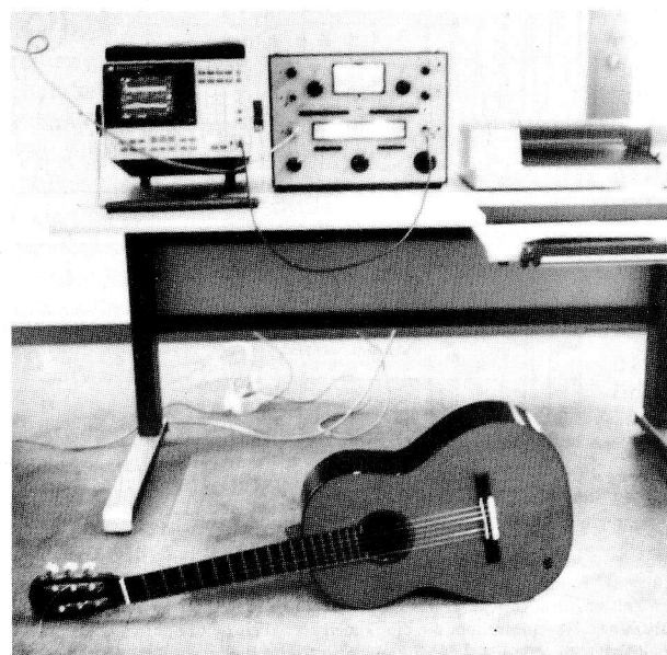
Bild 2: Anordnung des Meßplatzes im Demo-Zentrum Düsseldorf der Firma Hewlett Packard, v. l. n. r. FFT-Analysator, Mikrophon- Vor- und Endverstärker, Digital Plotter
